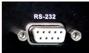
Der VIS-CATC-A Video Switch kann über RS-232 Schnittstelle gesteuert werden.
